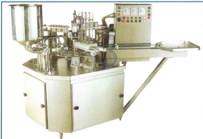
3-LINE FILLERS – CAPACITY UP TO 6750 CUPS PER HOUR LLENADORA DE 3-LINEAS – CAPACIDAD HASTA 6750 COPAS POR HORA
